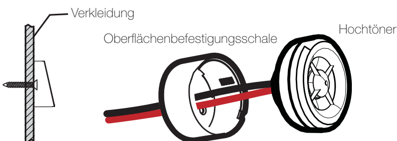
Abb. 6 Einbau auf der Oberfläche
